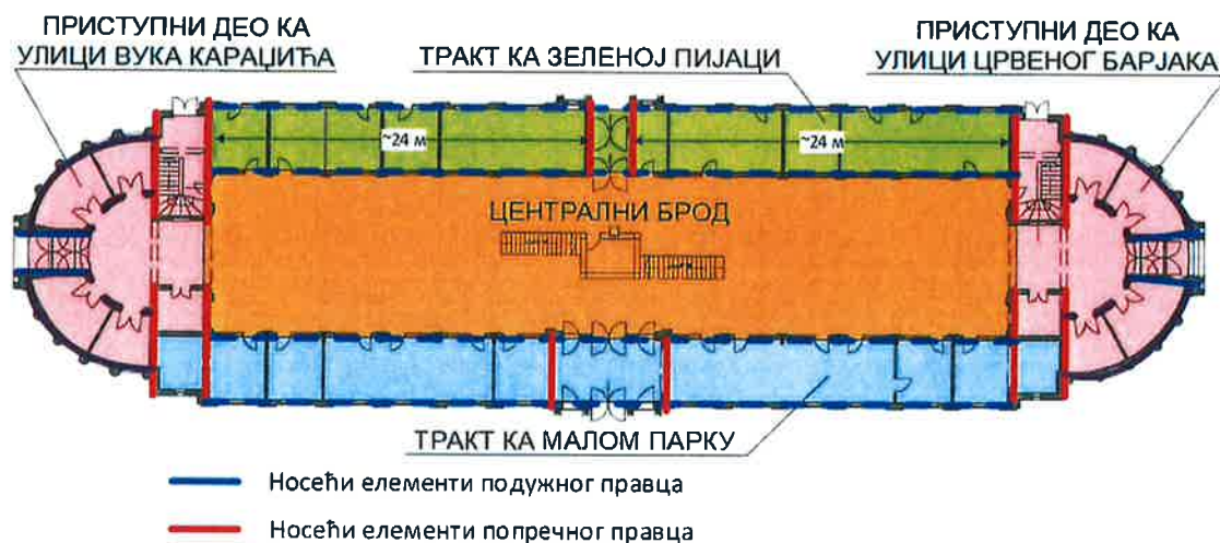
Слика 5 – Елементи за пријем хоризонталног оптерећења
